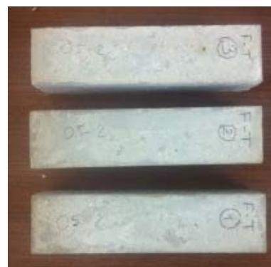
Şekil 10. O5 serisine ait numunelerin donma-çözülme çevrimi sonundaki görüntüsü
