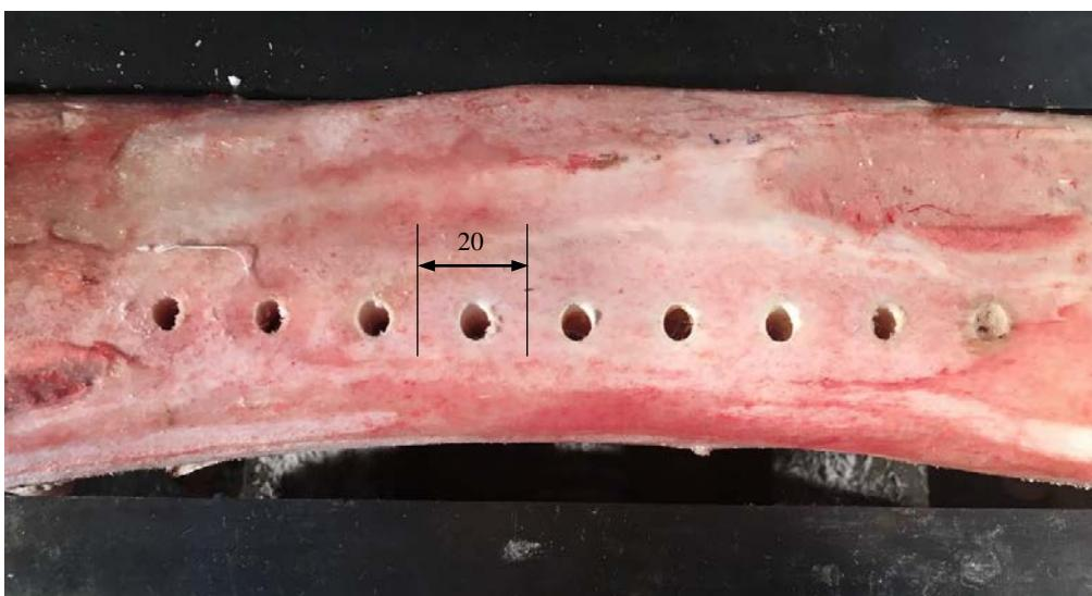
**Şekil. 2.** Deneyin yapılması ve delikler arası mesafe
