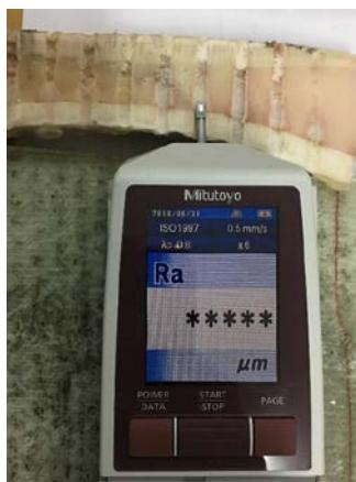
**Şekil. 3. Delik pürüzlülüğünün ölçümü**
