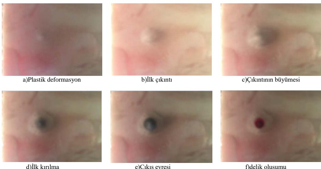
**Şekil. 8.** Delik çıkışında plastik deformasyonun oluşum evreleri
