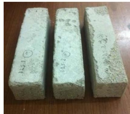
Şekil 8. D2.5 serisine ait numunelerin donma-çözülme çevrimi sonundaki görüntüsü
