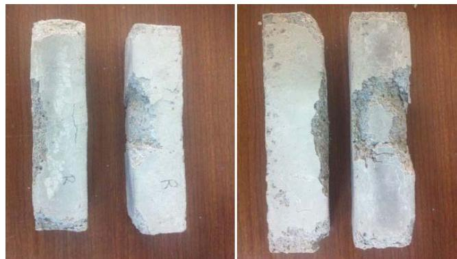
Şekil 7. Referans numunelerin donma-çözülme çevrimi sonundaki görüntüsü
