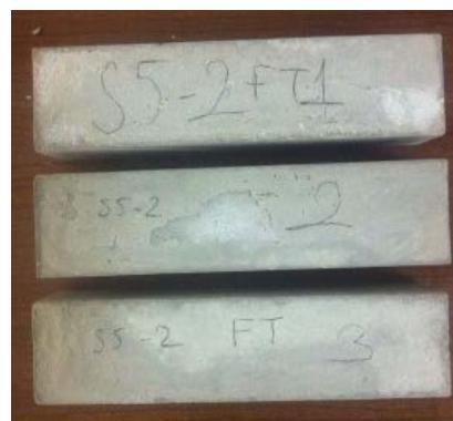
Şekil 9. S5 serisine ait numunelerin donma-çözülme çevrimi sonundaki görüntüsü
