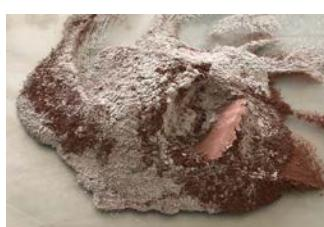
Şekil 3. Kil ile ponzanın kuru halde karıştırılması
