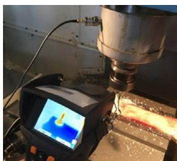
**Şekil. 4. Termal kamera ile delik girişindeki sıcaklık ölçümü**
